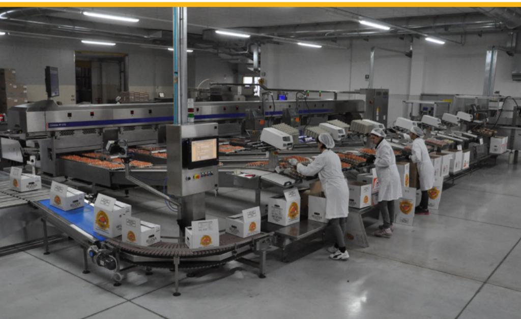
La linea di lavorazione è stata allestita installando attrezzature in grado di rilevare uova rotte, incrinate sporche per incrostazioni sul guscio o con tracce di sangue all'interno ed un impianto di disinfezione uova con raggi UV.
